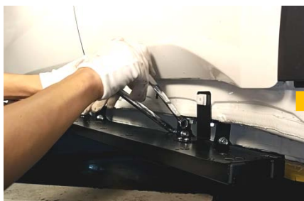
18. 拧紧15颗支架螺丝（拧紧力矩 22\text{N} \cdot \text{m} ）
