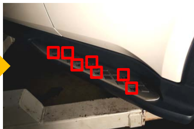
23. 拧紧7颗螺丝固定踏板底座和面板
