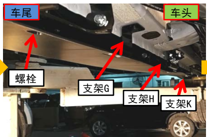
25. 安装G、H、K支架及螺栓 （右侧踏板对应支架为G、J、K）
