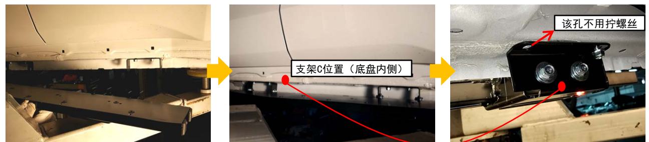
15. 安装支架C（用8*16法兰螺栓、8mm垫片临时固定，勿拧紧）
